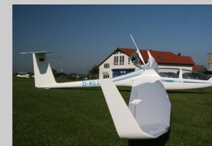
Segelflugzeuge mit Hilfsantrieb sind "richtige" Segelflugzeuge, die über ein Klapptriebwerk verfügen. Unsere DG-1000T (D-KLUM) ermöglicht so stressfreien Streckensegelflug.
